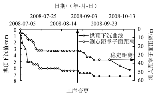
图11 拱顶下沉、测线距掌子面距离与时间的关系曲线
